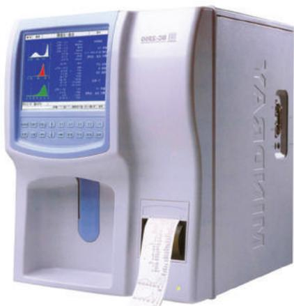
Гематологічний аналізатор BC-2800 Vet - це компактний повністю автоматичний гематологічний аналізатор для загального аналізу крові по 19 параметрам і технології відбору мікропроб. Зручний інтерфейс спрощує робочу процедуру і робить її більш ефективною. Завдяки попередньо запрограмованим налаштуванням для 13 тварин і 3 додатковим призначенням для користувача налаштуванням, він задовольнить потреби більшості ветеринарних лікарень.
